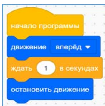
Рис. 18. Пример программы с использованием блока Ожидания
